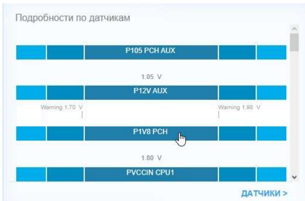
Рисунок 17 – Страница «Обзор»/Блок «Подробности по датчикам», отображение границ допустимых показаний датчика при наведении стрелки мыши
